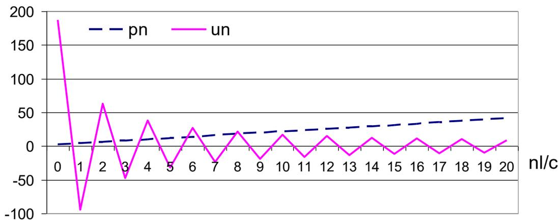
Рис. 3. Изменение давления и скорости газа на границах временных полос. Данные см. рис. 1.
