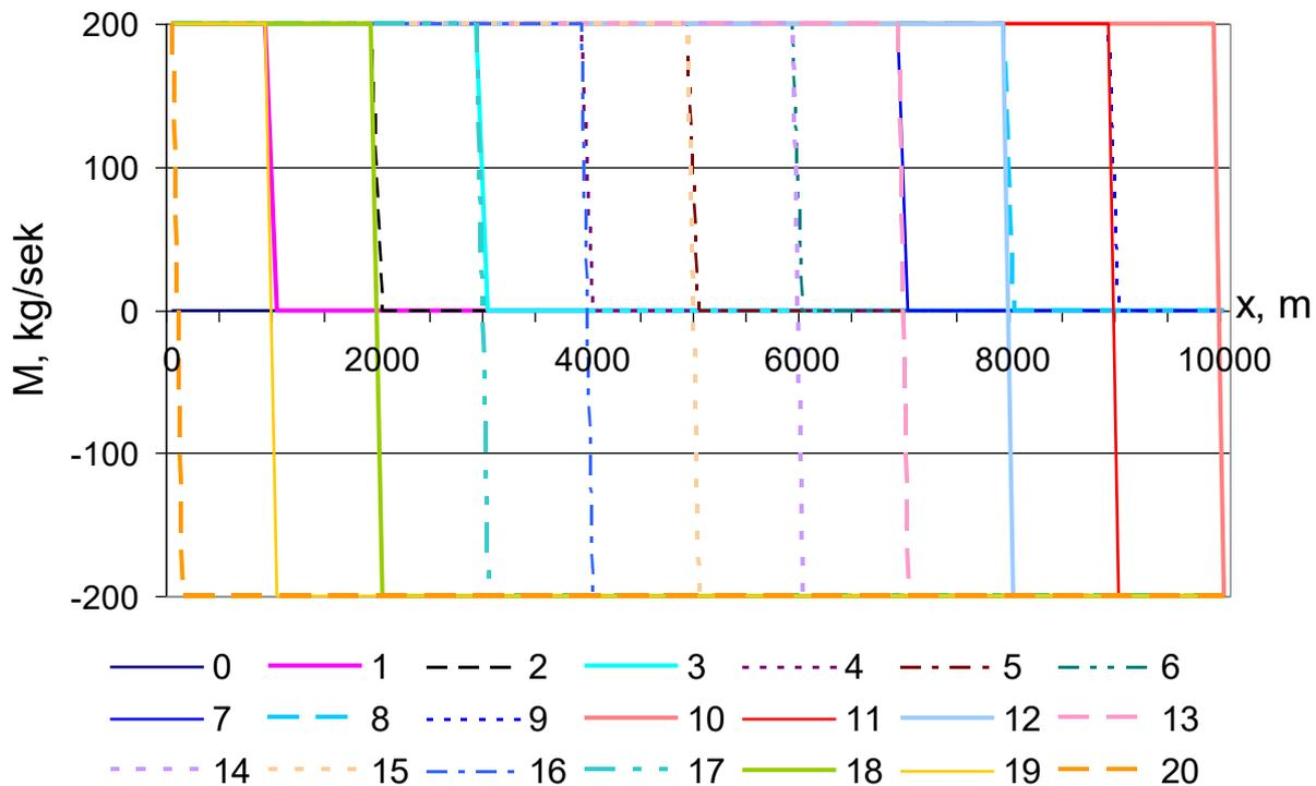
Рис. 1. Изменение массового расхода при  $0 \leq t \leq 2l/c$ .  $\psi_0^{(0)} = 200 \text{ кг/с}$ ,
