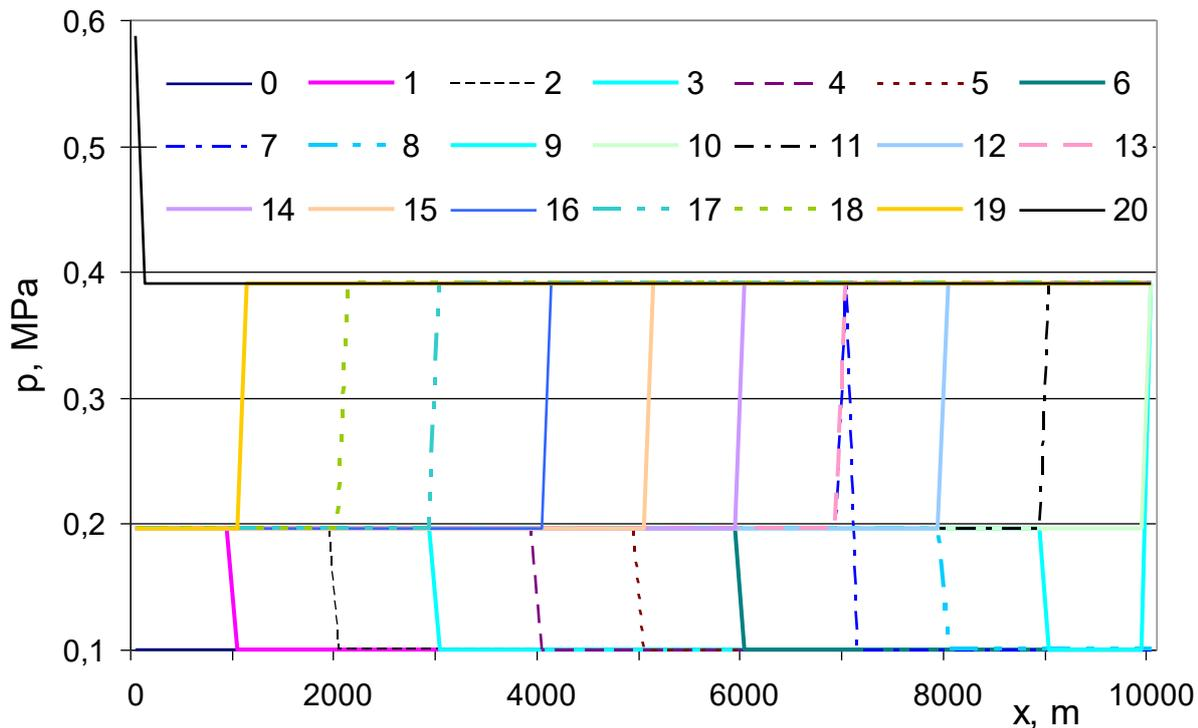
Рис. 2. Изменение давления газа при  $0 \leq t \leq 2l/c$ .  $p_0 = 0.1$  МПа.
