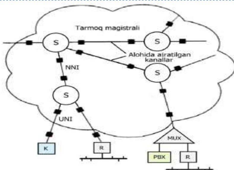
Bu erda quyidagi belgilar qo'llaniladi: S (switch) - kalitlar, K - kompyuterlar, R (router) - marshrutizatorlar, MUX (multipleksor) - multipleksor, UNI (User-Network Interface) - foydalanuvchi-tarmoq interfeysi va NNI (Network) -Network Interface) - interfeysli tarmoq - tarmoq [3].
