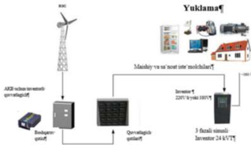
3-rasm. Shamol generator yordamida elektr energiya taminoti
