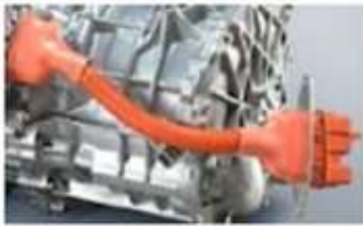
7-rasm. Gibril avtomobilining elektroxafsizlik sistemasi
