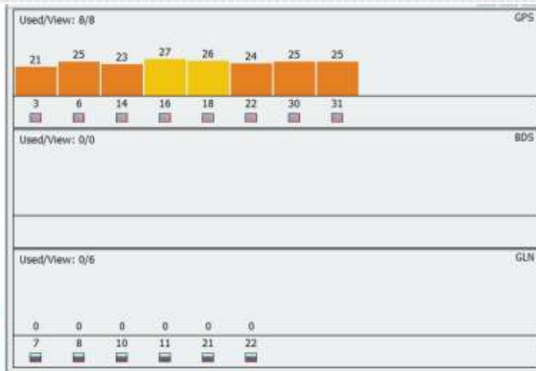
Рисунок 8 – Уровни сигнала видимых НС GPS при помехе
